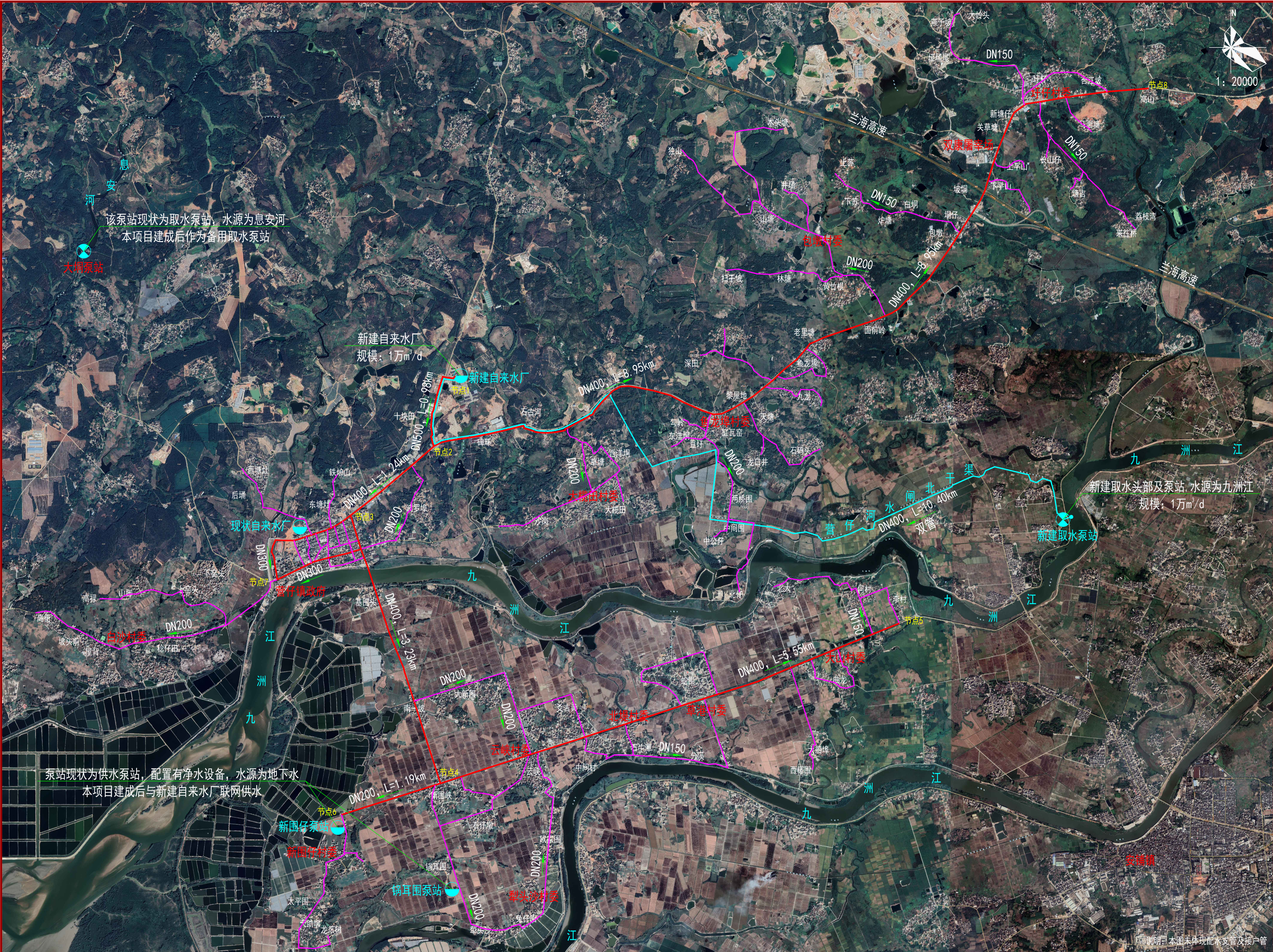
输配水管网总平面布置图 1:20000
